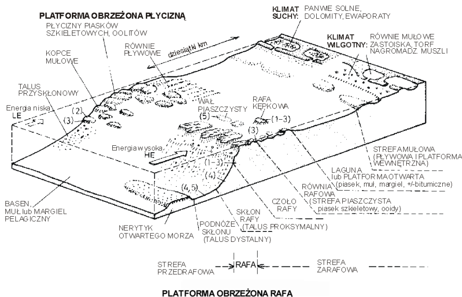
Ryc. 56. Platforma węglanowa szelfu obrzeżona płyczną: fizjografia i osady (Einsele 1992)
