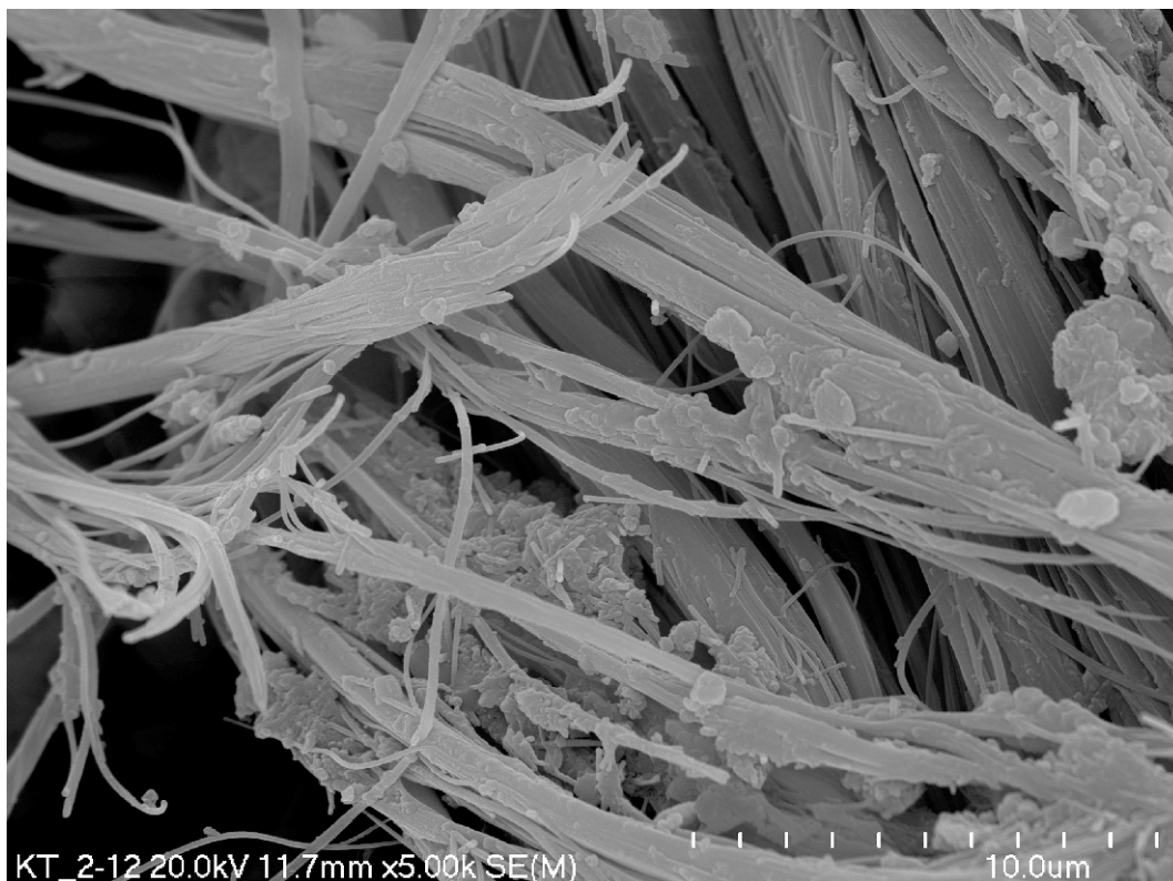
Obraz uzyskany z wykorzystaniem elektronów wtórnych (wierzająca powierzchnia płyty eternitowej, powiększenie 5 000 razy)
